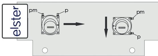
**Brug tussen de onderste klemmen** (leveringstoestand): Het **bovenste** telwerk is geactiveerd Doorstroomrichting: van **onder naar boven** of van **rechts naar links**.
