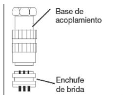
**Aviso!** Todos los emisores de impulsos son intrínsecamente seguros y, en caso de emplearse en **atmósferas potencialmente explosivas**, sólo se pueden conectar a **circuitos eléctricos intrínsecamente seguros**. Las barreras de seguridad deben cumplir los requisitos del tipo de protección **EEx ib IIC** (ver marcado específico en el Anexo A).
