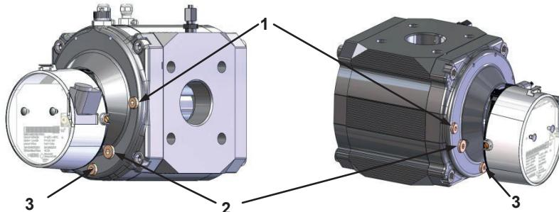
**1** = Einfüllstutzen für Öl   **2** = Ölstandskontrolle Erstbefüllung   **3** = Ablaßstutzen für Öl oder Ölsaugglas
