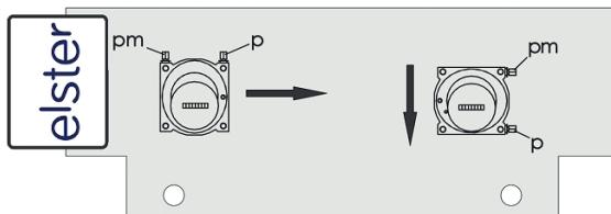
**Cavallottaggio dei morsetti inferiori** (stato di fornitura): il totalizzatore **superiore** è attivato Direzione di flusso: dal **basso verso l'alto** o da **destra a sinistra**:
