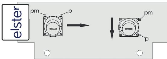
**Puente de los bornes inferiores** (estado de suministro): está activado el totalizador superior. Sentido del flujo: de **abajo hacia arriba** o de **derecha a izquierda**.
