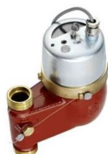
Meerstraals mechanische flowmeter, deze kan enkel verticaal gemonteerd worden en is verschillend voor val- en stijgleidingen.
